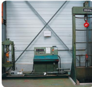
Banc d'essai de 20 tonnes
