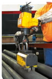
Porteur magnétique pour levage de cylindres
