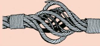
Cage d'oiseaux (câble de 6 torons) causée par des chocs lors du travail sous charge.
